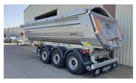
Châssis acier avec benne acier Hardox 500 Volume 24m3
